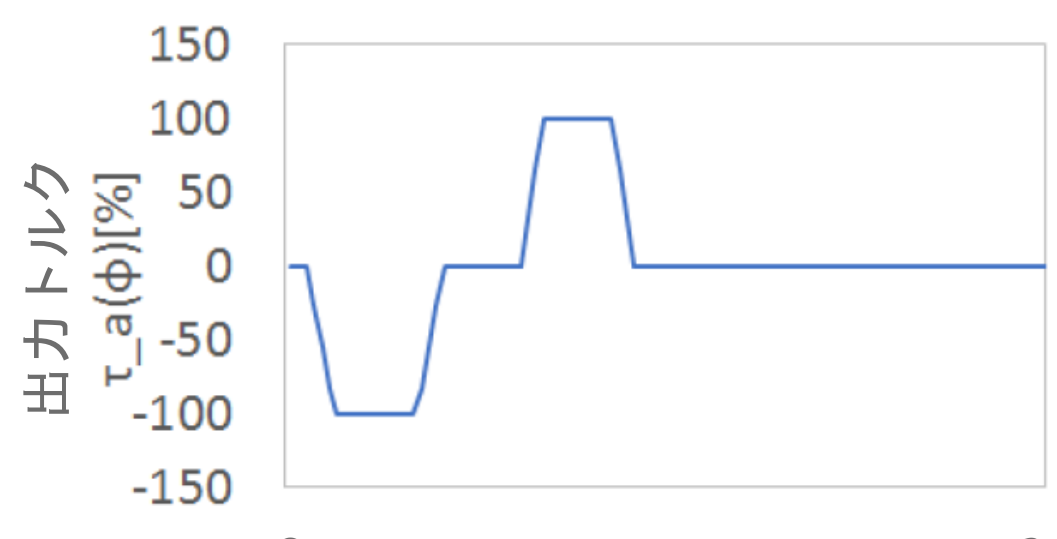
歩行中のトルクテーブル 位相角に応じて出力トルクを決定
